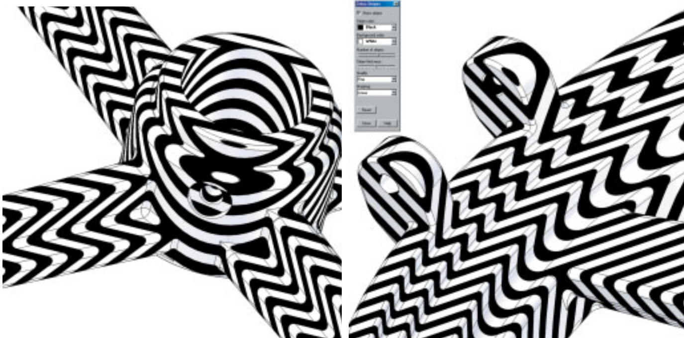
Rys. 2. Analiza typu „zebra“ w ogromnym stopniu ułatwia wykrywanie nieciągłości powierzchni oraz ich krawędzi.
