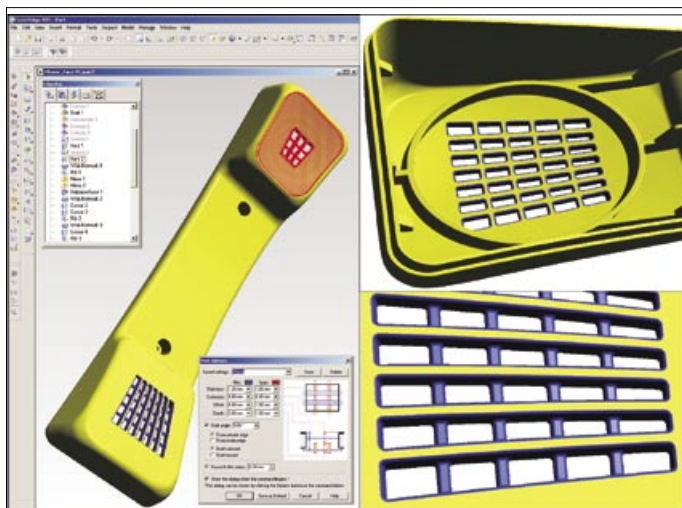
Rys. 2. Kratka głośnikowa w modelu 3D obudowy telefonu, wykonana z zastosowaniem narzędzia Wentylacja
