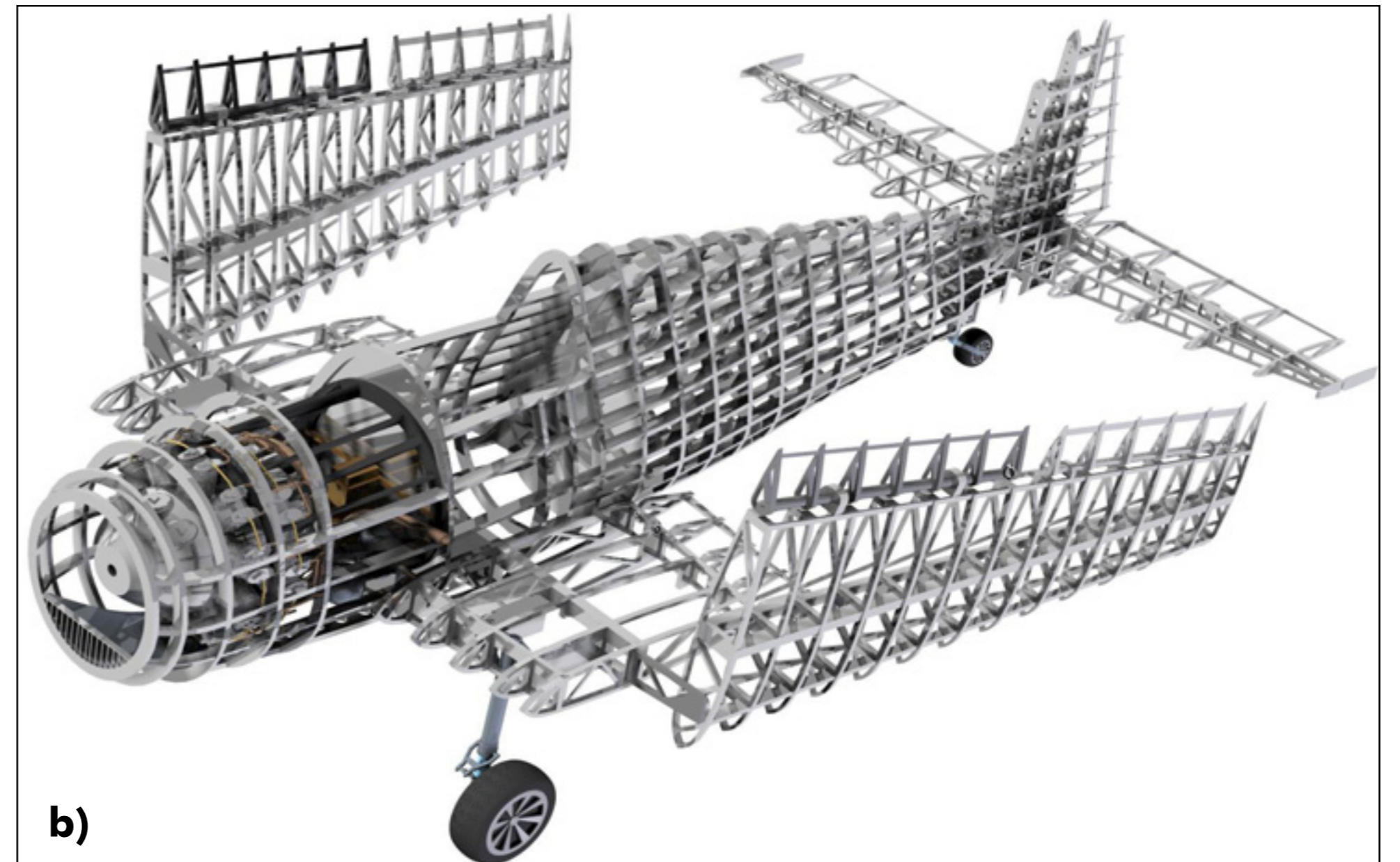
Rys. 1. Szkielet płatowca: a) struktura, b) częściowy demontaż skrzydeł celem hangarowania
