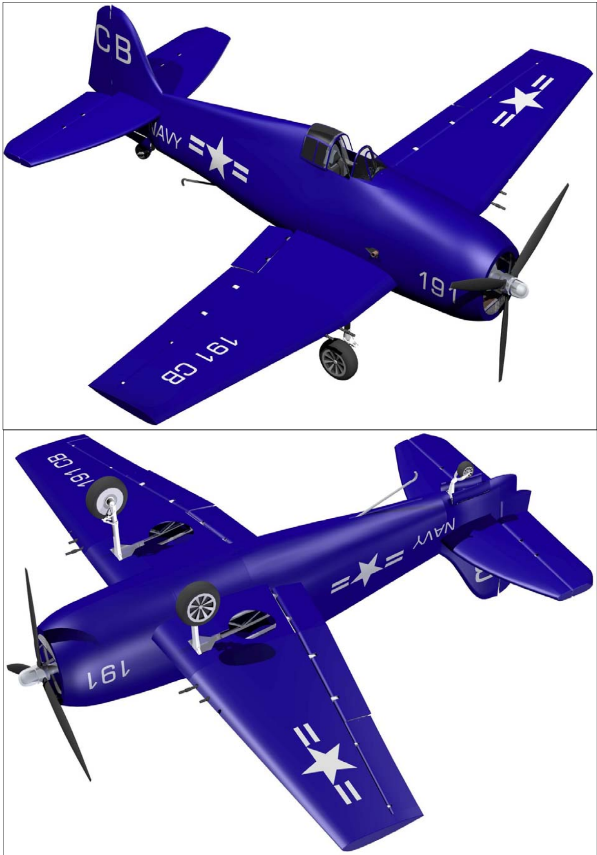
Rys. 7. Ukończony model 3D samolotu wojskowego Grumman F6F-5 Hellcat (uwagę zwraca poszycie płatowca z naniesionymi taktycznymi znakami rozpoznawczymi, wiatrochron i owiewka oraz wyposażenie wnętrza kabiny pilota, a także hak do lądowania na pokładzie lotniskowca)
