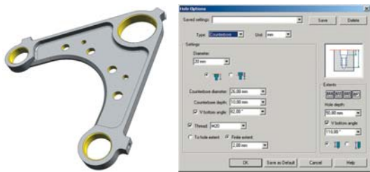
Rys. 9. Narzędzie Hole umożliwia wykonanie i edycję w krótkim czasie wielu otworów
