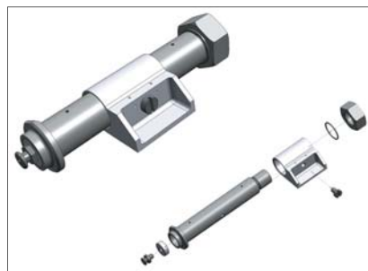
Rys. 13. Stosując narzędzie Exploded View można uzyskać tzw. widoki rozstrzelone
