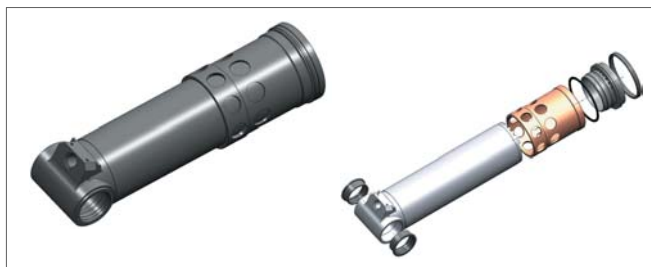
Rys. 10. Model tłoczyska amortyzatora powstał jako integralna całość. Podzielono go na części składowe dzięki poleceniu Divide Part
