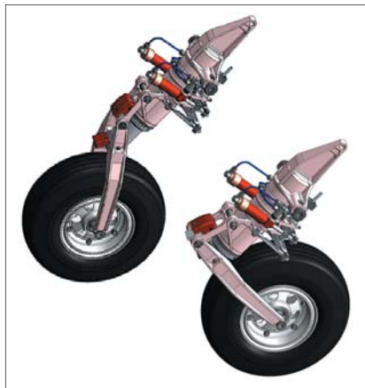
Rys. 15. Zastosowanie narzędzia Family of Assemblies umożliwia m.in. natychmiastową zmianę konfiguracji modelu odpowiadającą np. dwóm jego skrajnym położeniom
