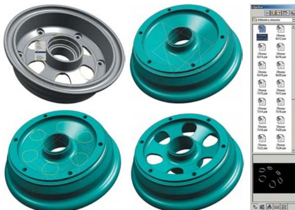
Rys. 4. Feature Library – narzędzie umożliwiające szybkie zapożyczenie wybranych operacji technologicznych pomiędzy podobnymi częściami
