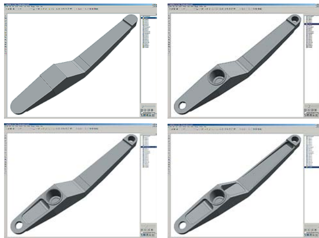
Rys. 2. Wybrane etapy powstawania części zilustrowane dzięki narzędziu Feature Playback
