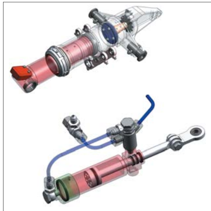
Rys. 14. Nadanie wybranym częściom efektu przezroczystości lub pokrycie ich kontrastującymi ze sobą kolorami wpływa na jakość wizualizacji zespołu części
