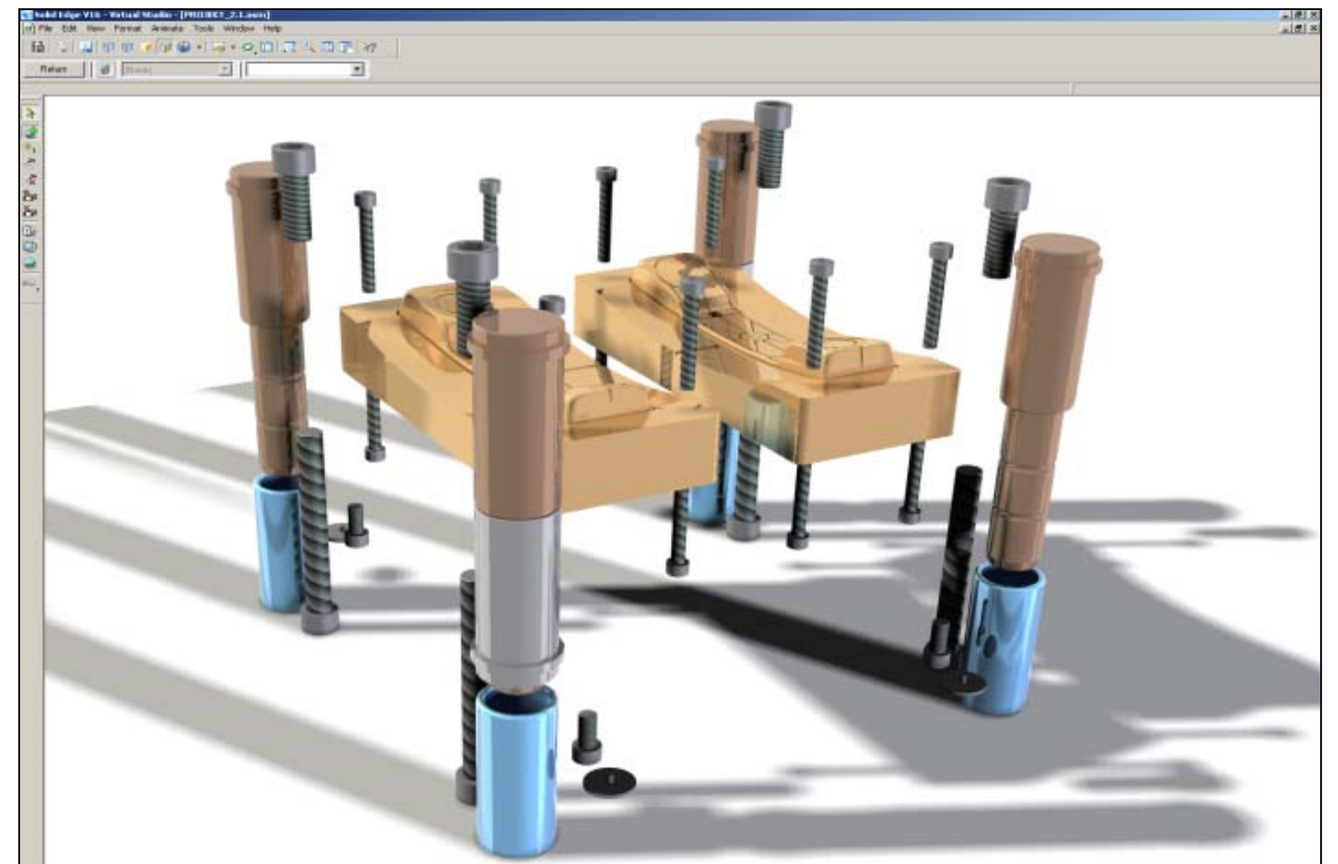
Rys. 6. Wykonywanie modeli MCAD osprzętu formy
