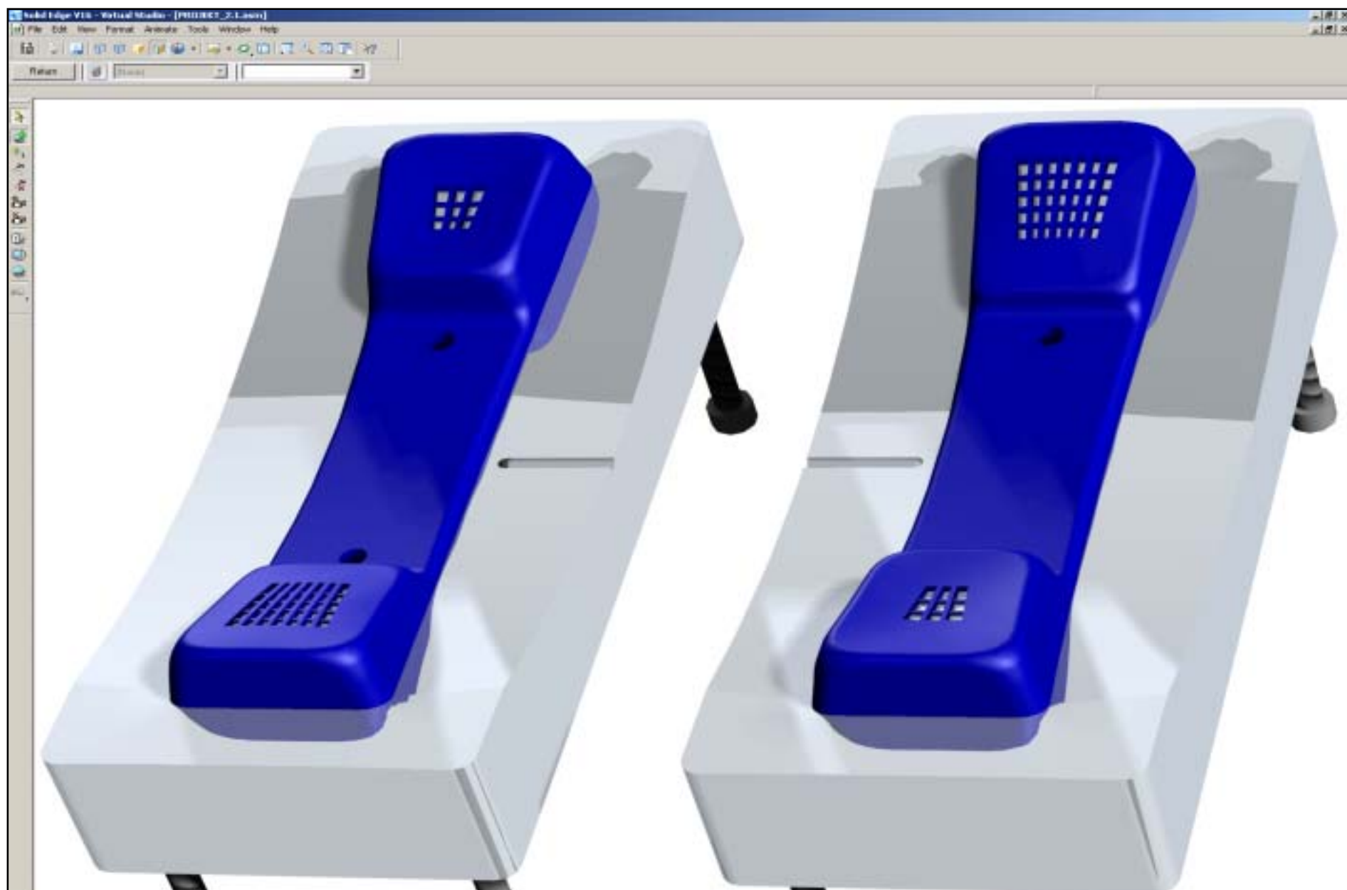
Rys. 3. Rozmieszczenie wyprasek, generowanie wkładek
