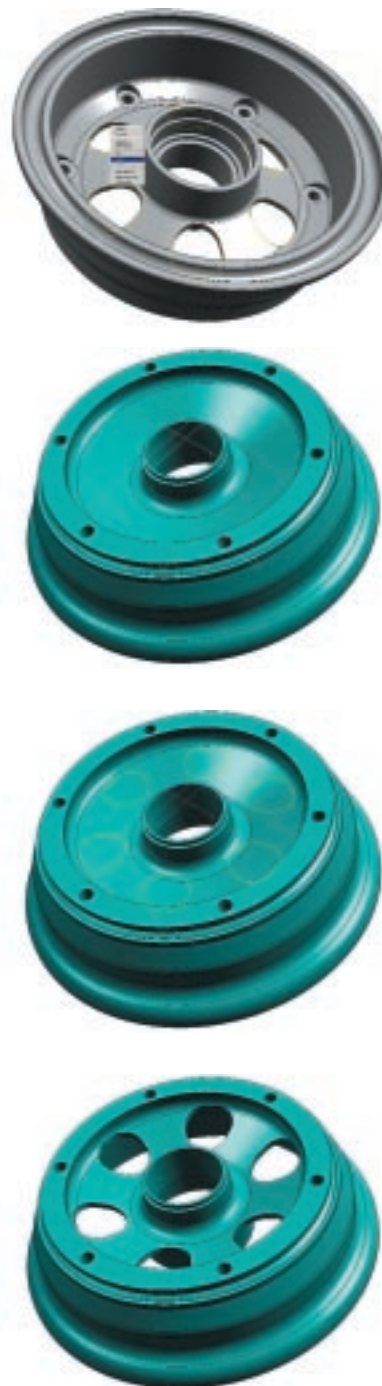
Rys. 4. Feature Library – narzędzie umożliwiające szybkie zapożyczanie wybranych operacji technologicznych pomiędzy podobnymi częściami. Na sąsiedniej stronie - okno dialogowe sterujące zmianami.
