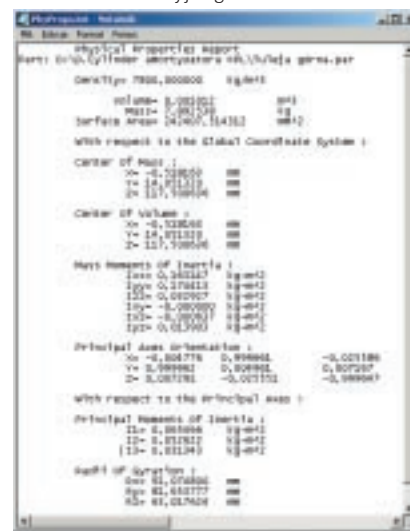
Rys. 6. Przykłady wyeksportowania informacji dotyczących właściwości fizycznych konstruowanej części.
