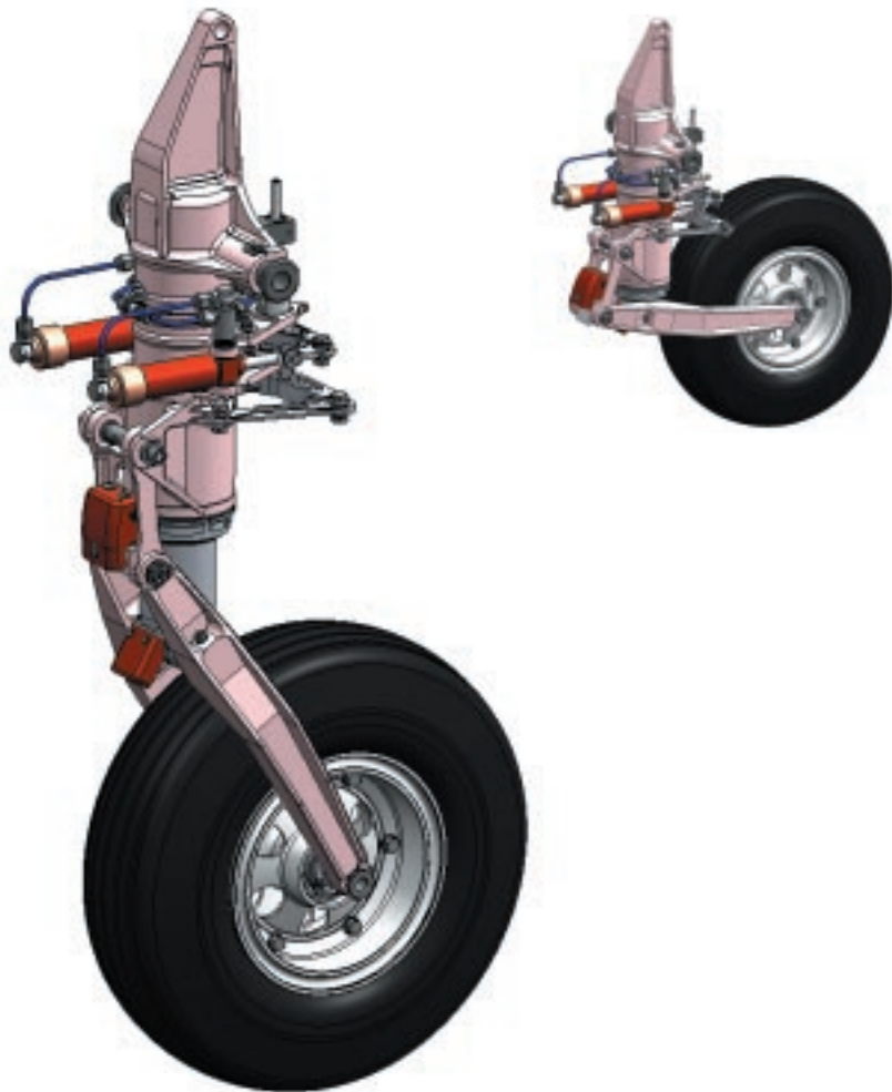
Rys. 15. Zastosowanie narzędzia Family of Assemblies umożliwia m.in. natychmiastową zmianę konfiguracji modelu odpowiadającą np. dwóm jego skrajnym położeniom.
