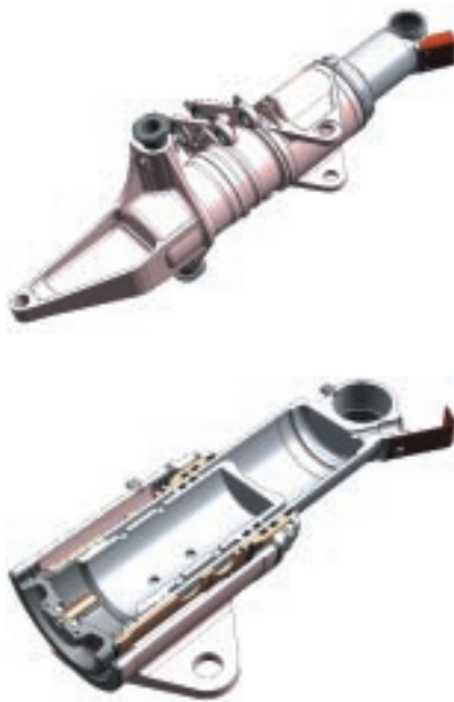
Rys. 12. Widok całkowity amortyzatora oraz jego widok częściowy uzyskany dzięki poleceniu Cutaway View.
